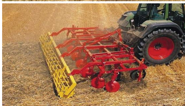
شکل ۱۲- خاک ورز مرکب (چیزل با تیغه‌های پنجه‌غازی + دیسک + غلتک)
